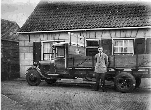
Jan de Man voor het pand van Marinus van Beek, bij een door hem gebouwde vrachtwagen. De laadbak en de cabine zijn hoofdzakelijk van hout.
